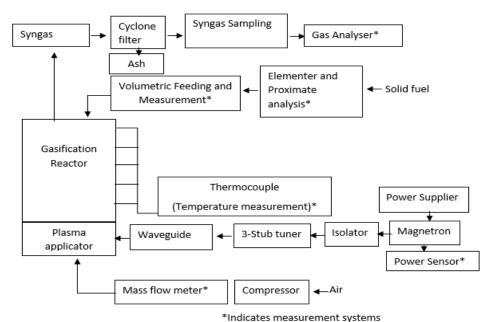
Figure 2. Block diagram of MCw GASIFIER
